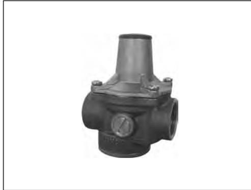
Клапаны редукционные типа 7BIS являются регуляторами давления прямого действия «после себя» и предназначены для снижения и поддержания постоянного давления за клапаном вне зависимости от колебаний давления до него.
